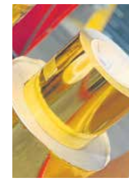
Folien für die Heißfolienprägung.
