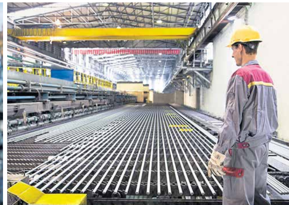
Gewalzt, abgeschreckt: fertige Bewehrungsstäbe.
