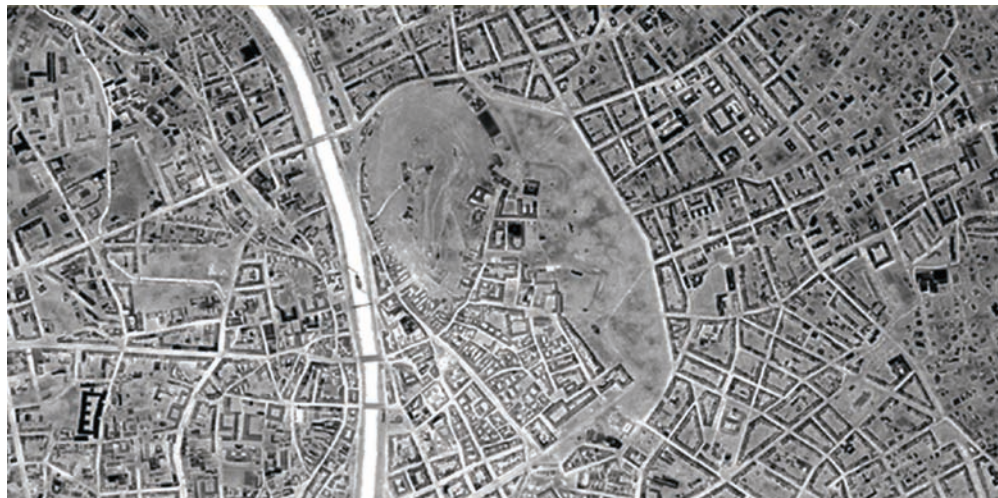
Abbildung 14: TABI-1800-Aufnahme vom 20.12.2011 (hell: warm, dunkel: kalt)
