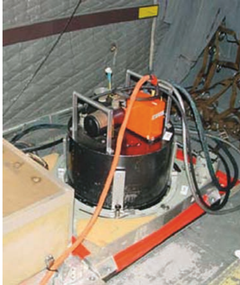
Abbildung 5: Konfiguration des Multispektralscanners DAEDALUS (Quelle: DLR)
