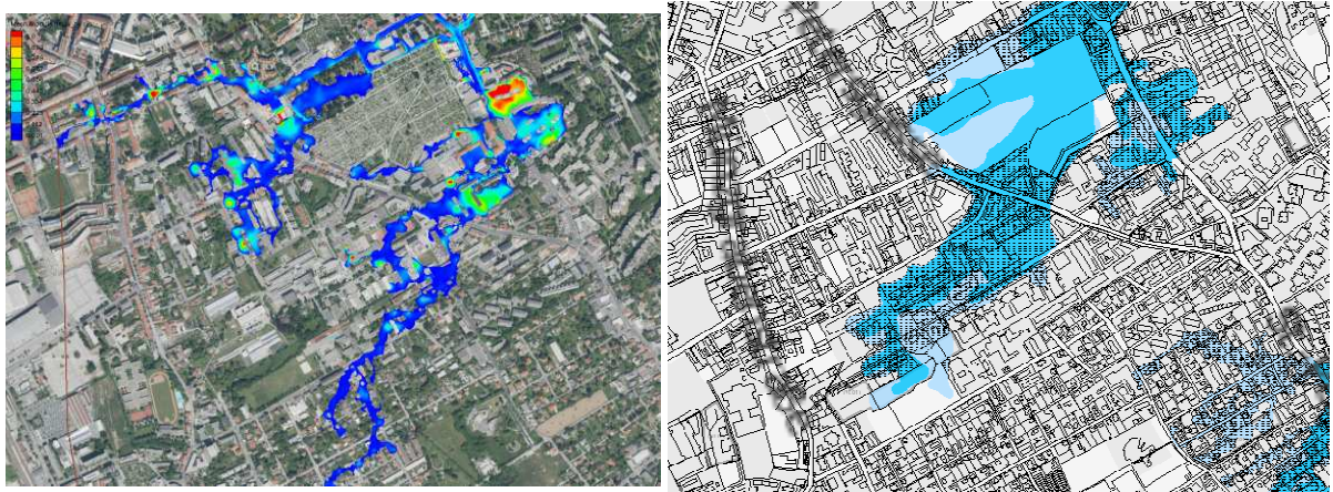
Abbildung 37: Hochwasserabflussbereich HQ30 (links) hydroconsult GmbH, und HQ30/100 siehe FWP 4.02
