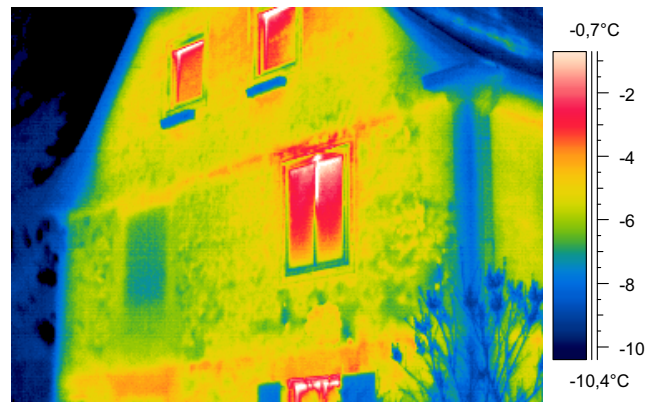
Wesentliche Verbesserung des Sockelbereiches, keine erhöhten Wärmeverluste erkennbar.
