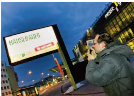
Abb. 55 – Leuchtdichtemessung an einer Videowall
