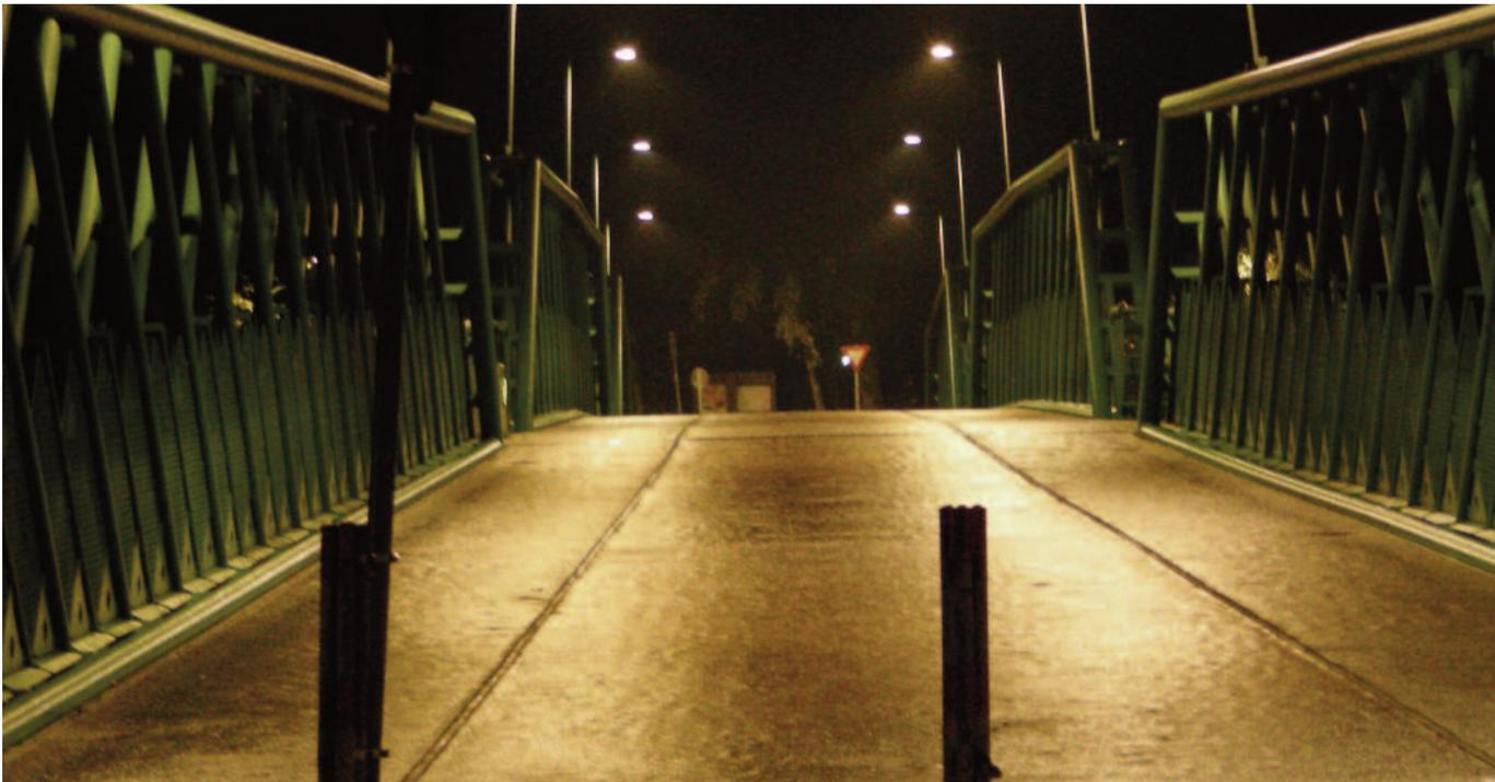
Abb. 26 - warmweiße Leuchtmittel mit weniger als 3000 K Farbtemperatur sind zu empfehlen
