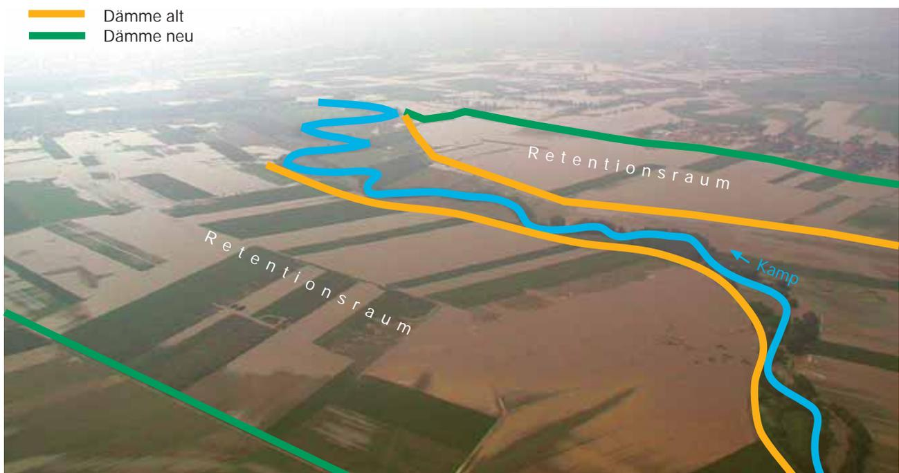
▲ Der Kampfluss beim Hochwasser 2002. Das Flussumland wird großräumig überflutet. Im Bild grün markiert die abgerückten Dämme zur Schaffung großer naturnaher Überflutungsräume, in denen sich die Kraft des Wassers bricht.
