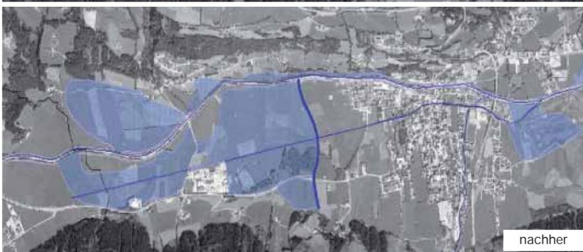
▲ Hochwasserschutz Mittersill: Überflutungsflächen bei HQ<sub>100</sub> vor (o.) und nach (u.) Projektausführung.
