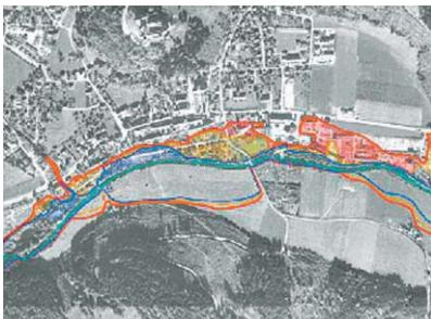
**Hochwasseranschlaglinien.** *Moderne computergestützte Rechenmodelle ermöglichen die exakte Berechnung der Ausbreitungsgrenzen von Hochwässern bei verschiedenen Katastrophenszenarien. - Eine unerlässliche Planungs- und Entscheidungshilfe.*
