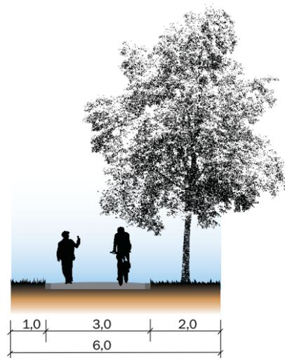
**Regelquerschnitt für Geh- und Radweg**
