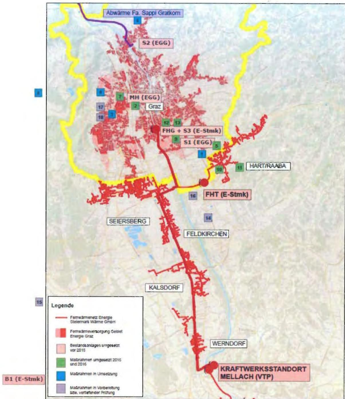
Abbildung 10: Übersicht der Einspeiseanlagen in das Fernwärmnetz im Großraum Graz
