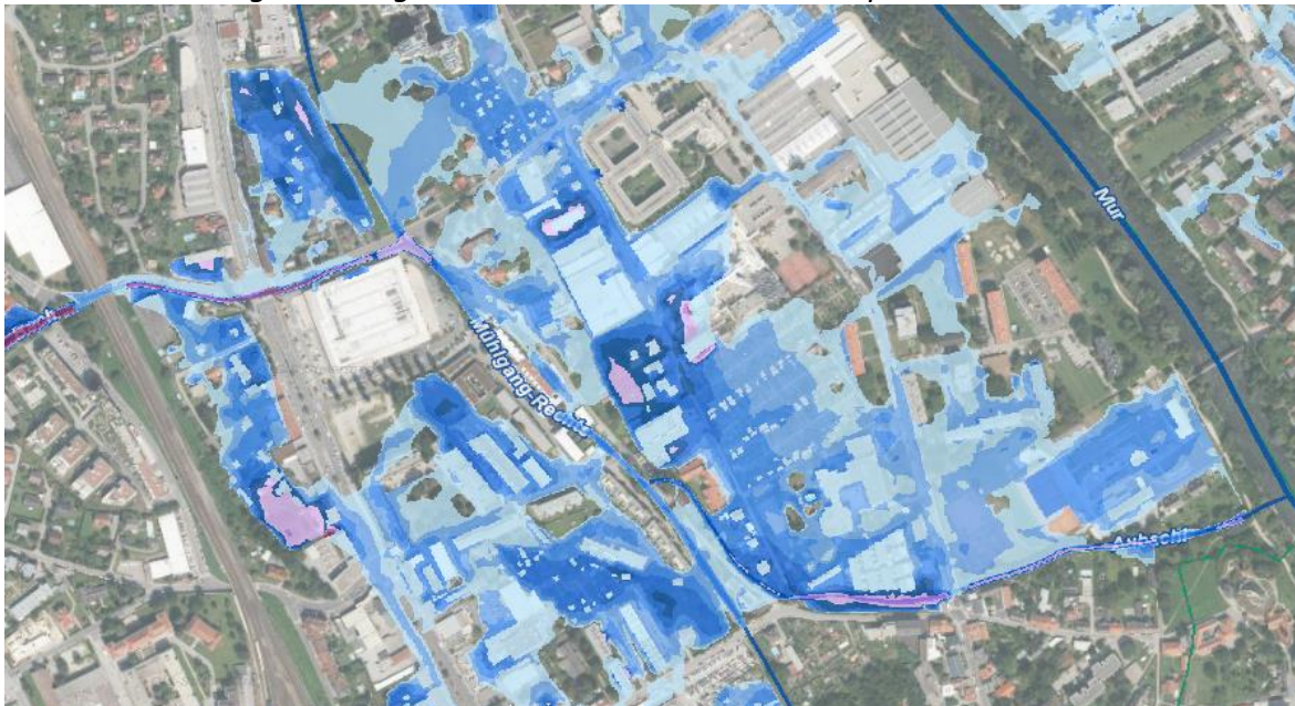
Abbildung: Hochwasserabfluss Thalerbach HQ 30 [Quelle GIS Stmk]
