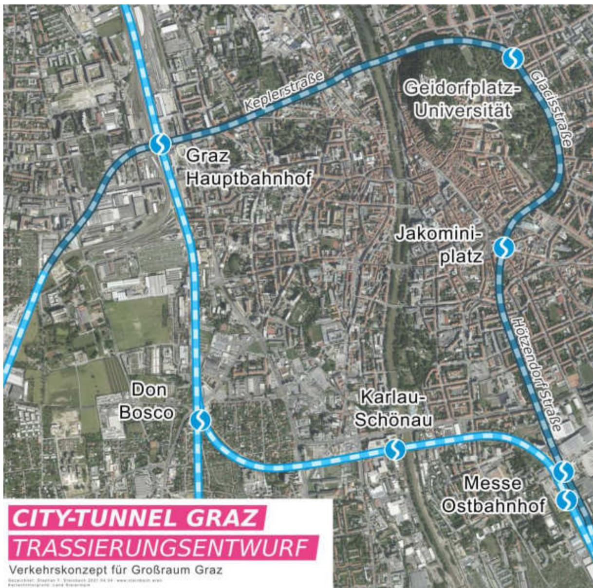
Abb. 33: S-Bahn-Tunnel - kurz - Trassierungsentwurf
