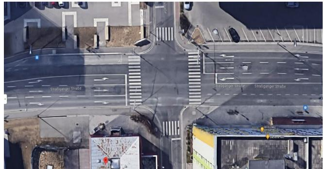
Um möglichen Unfällen präventiv zu entgegnen und einen flüssigen Verkehr sicherzustellen, ist eine Korrektur der Haltelinie nach hinten notwendig.
