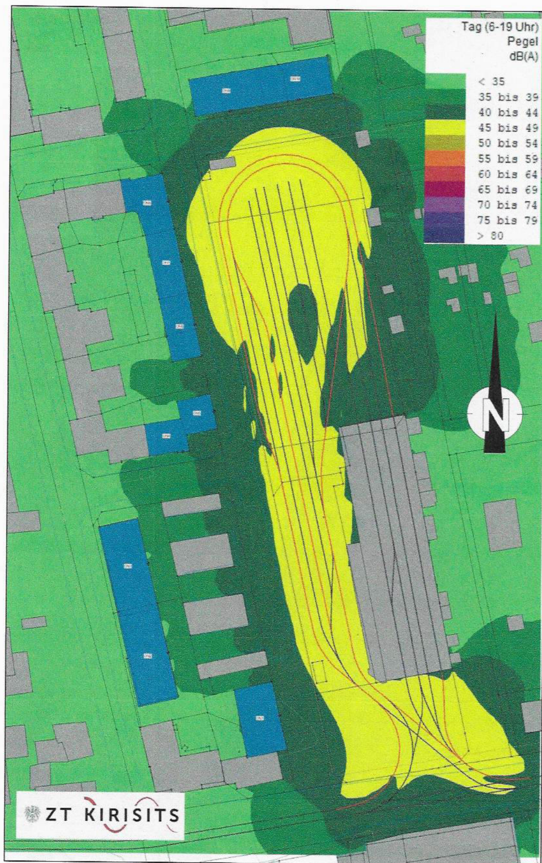
Abb. 15: Lärmkarte Tag – Remise 3 – Bestand – Höhe 4 m über Boden
