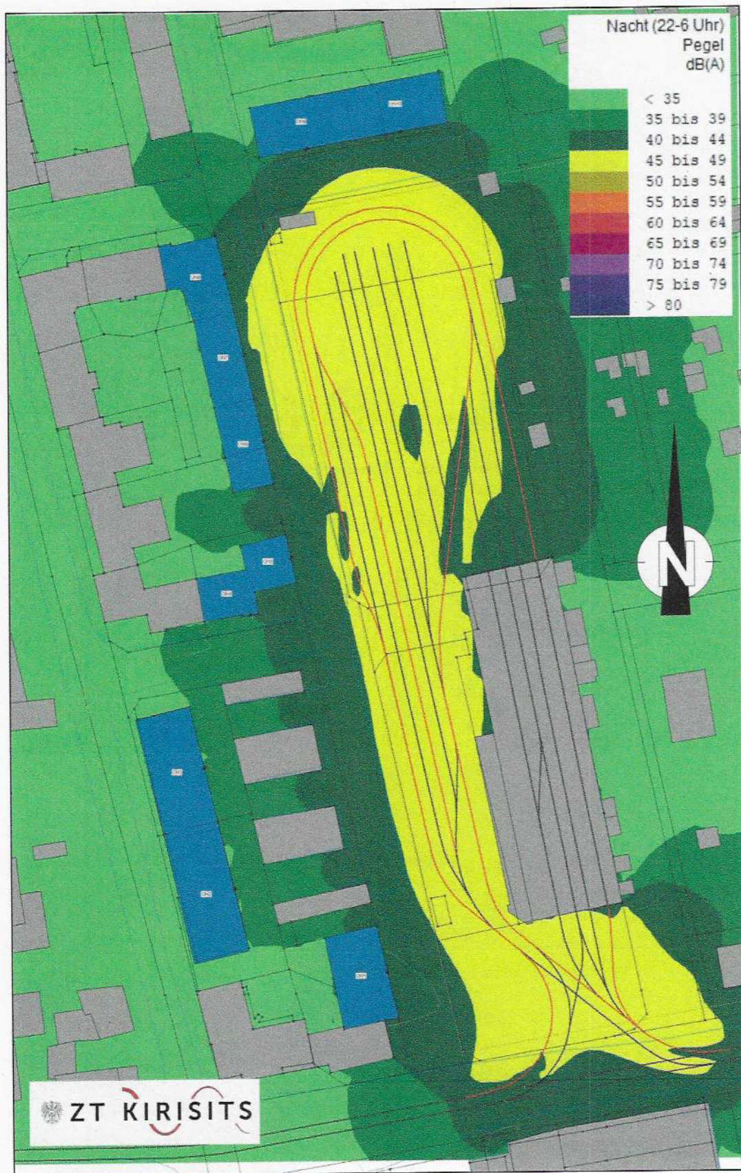
Abb. 16: Lärmkarte Nacht – Remise 3 – Bestand – Höhe 4 m über Boden
