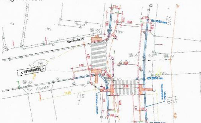
Abbildung 12: Schutzwegausbau Babenbergerstraße beim Knoten Stahlgasse
